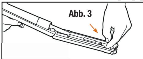
Setzen Sie ein 4,5 mm Pellet ein (Abb.3).
