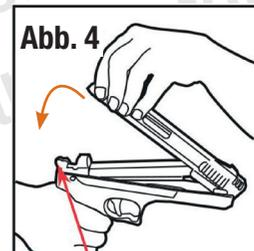
Schließen Sie die Luftpistole, indem Sie mit der freien Hand die Laufeinheit nach unten drücken (Abb. 4), bis sie in den Verschluss einrastet. Das Schließen der Laufeinheit erfordert etwas Kraft, da gleichzeitig der Druck aufgebaut wird.
