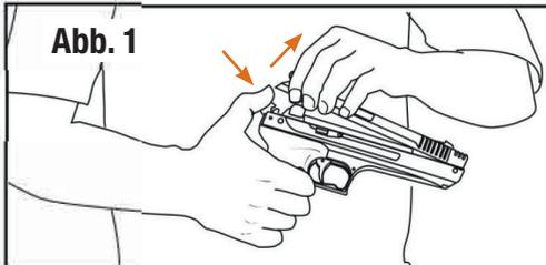
Richten Sie Ihre Luftpistole in eine sichere Richtung. Halten Sie Ihre Finger vom Abzug fern und lösen Sie die Laufeinheit, indem Sie den Hahn mit dem Daumen nach hinten und unten ziehen (Abb. 1).
