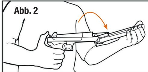
Heben Sie gleichzeitig mit der freien Hand die Laufeinheit an und schwenken Sie sie ganz nach vorne (Abb. 2).
