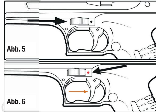
Zielen Sie auf ein sicheres Ziel, bevor Sie die Waffe entsichern. Die automatische Sicherung (Abb. 5) befindet sich oberhalb des Abzugsbügels.
