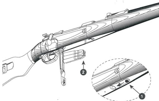
(1) Schieben Sie die Schraubenapplikation in Richtung Abzug. Die Verschlussklappe (2) öffnet sich dann automatisch.
