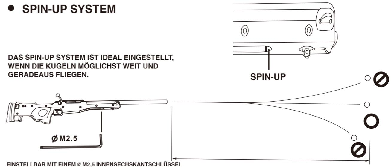
EINSTELLBAR MIT EINEM Ø M2,5 INNENSECHSKANTSCHLÜSSEL
