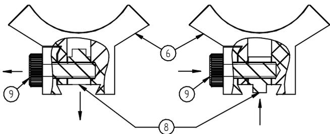
Danach das Zielgerät in die beiden unteren Ringhälften (6) der Montage einlegen und die beiden oberen Ringhälften (7) wieder aufschrauben, dabei die Schrauben nur leicht anziehen, Horizontal- und Vertikaleinstellung vornehmen und die Schrauben fest anziehen (Abb. B).
