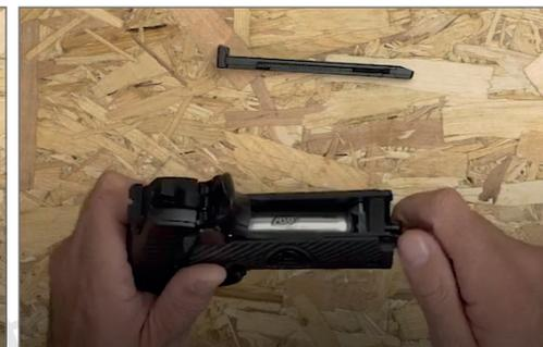
Lösen Sie die Feststellschraube und platzieren Sie eine 12g CO<sub>2</sub>-Kapsel im Griffstück. Drehen Sie die Feststellschraube im Uhrzeigersinn fest, um die CO<sub>2</sub>-Kartusche anzustechen. Vergewissern Sie sich, dass die Kartusche durchstoßen wurde aber überdrehen Sie die Schraube nicht!
