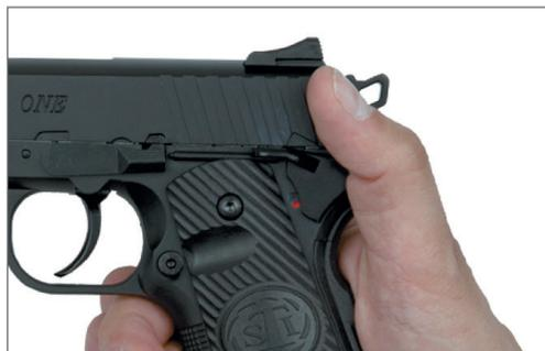
Die Sicherung befindet sich auf der rechten Seite über dem Abzug. Entsichern Sie die Waffe erst kurz vor der Schussabgabe. Drücken Sie den Sicherungshebel nach oben, um die Waffe zu sichern (kein roter Punkt sichtbar = gesichert).
