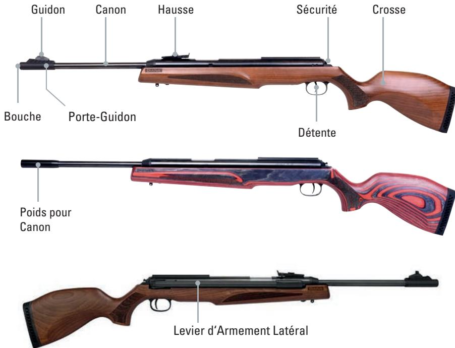
**Remarque pour Modèle 54:** Le modèle 54 est une carabine à air comprimé de longue portée, sans recul, à canon fixe et levier d'armement latéral. Le recul est amorti par un mécanisme anti-recul. Lors du tir, le mécanisme de l'arme se déplace de 15 mm vers l'arrière.
