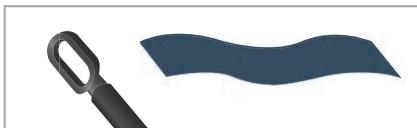
1. Attachez un chiffon de coton à l'extrémité d'une tige de nettoyage appropriée.
