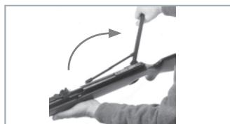
1. El amartillado y carga se realizan abriendo y desplazando la palanca de amartillado lateral hasta el tope.
