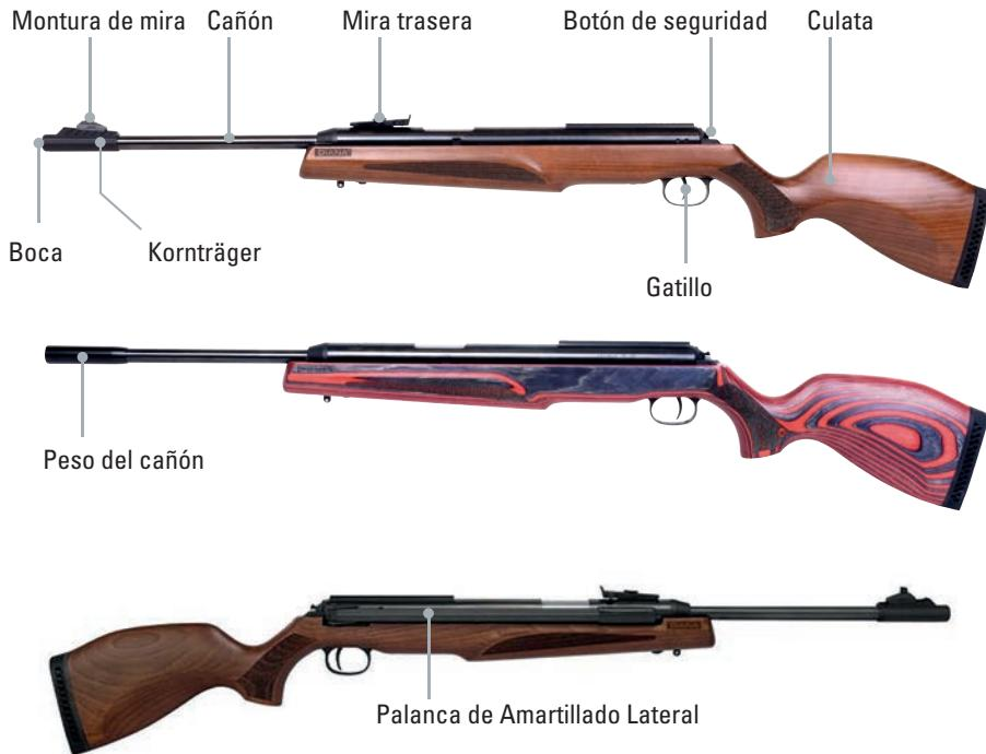
**Observaciones para el modelo 54:** El modelo 54 es una carabina de aire para larga distancia precisa, potente y sin retroceso con cañón fijo y palanca de amartillado lateral. La supresión del retroceso se ha logrado mediante un sistema de freno de retroceso novedoso. El sistema de la carabina se desplaza aprox. 15 mm hacia atrás al realizar un disparo.
