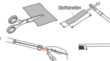
Drehen Sie den Stoffstreifen um den Reinigungsstab.
