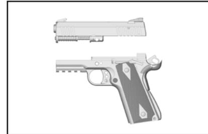
**Abb. 4: Verschluss komplett entfernt**
