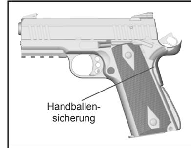
Abb. 3: Handballen Sicherung
