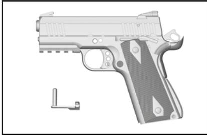
**Abb. 1: Verschlussfanghebel entfernt**
