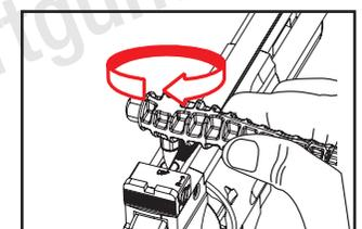
Drehen Sie die Schrauben im Uhrzeigersinn, um diese zu befestigen.
