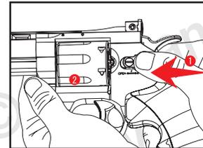
Drücken Sie mit dem rechten Daumen die Trommel-Entriegelung nach unten und mit der linken Hand drücken Sie die Trommel von hinten heraus.
