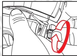
Drehen Sie das Verschlussystem zügig im Uhrzeigersinn, um die CO<sub>2</sub>-Kapsel zu aktivieren. Bringen Sie anschließend die Griffabdeckung wieder an.
