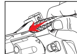
Drücken Sie den Pin wie abgebildet mit dem Sechskantschlüssel raus.
