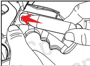
Positionieren Sie eine 12g CO<sub>2</sub>-Kapsel im CO<sub>2</sub>-Fach.
