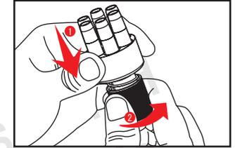
Drücken Sie den Speedloader nach unten und drehen Sie ihn nach rechts, um die Hülsen zu verriegeln.
