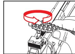
Stellen Sie sicher, dass die Waffe gesichert und nicht geladen ist. Drehen Sie die Schraube gegen den Uhrzeigersinn, um diese zu lösen.
