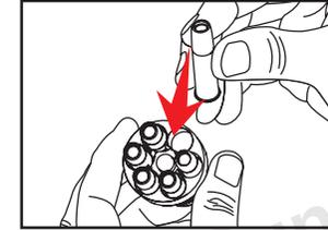
Setzen Sie die Hülsen in den Speedloader.
